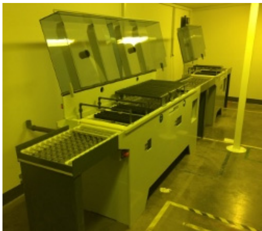
Kette aus Entwicklersprint 4500 und Ätzsprint 4500 mit 4-facher Ätzzone
